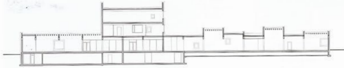
Coupe longitudinale montrant les réserves au sous-sol, les deux étages de bureaux et les espaces d'exposition au rez-de-chaussée
